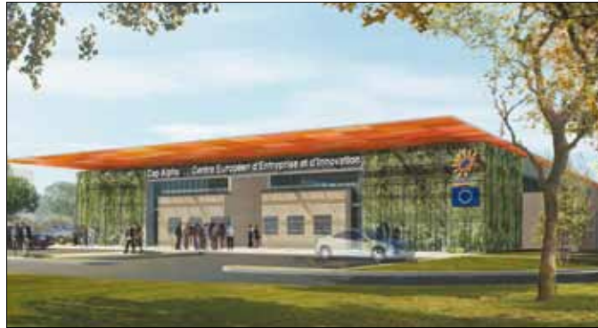
Les besoins en énergie du bâtiment seront couverts en partie par la production des 550m 2 de panneaux photovoltaïques posés sur la toiture.
