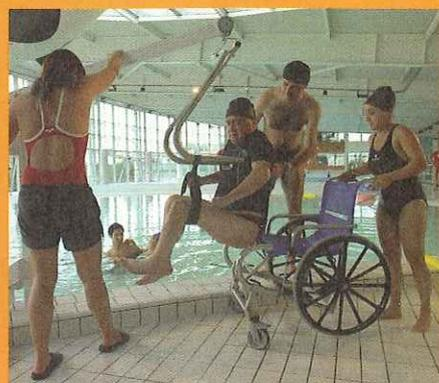
Disponible à la piscine Amphitrite, le souleve personne mobile permet de passer plus facilement de la chaise roulante aux bassins, ludique ou sportif. Ce système de levage électromécanique, monté sur roues, soulève la personne et la descend lentement dans l'eau.
