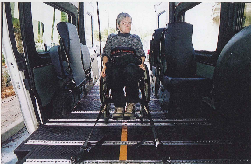
Un système de sécurité composé de Quicklock, de sangles, de ceinture de sécurité, permet de fixer le fauteuil. PHOTO : MONTPELLIER AGGLOMÉRATION
